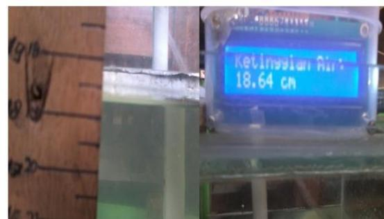
Gambar 6. Hasil Pengujian Sensor Ultrasonik pada Alat
