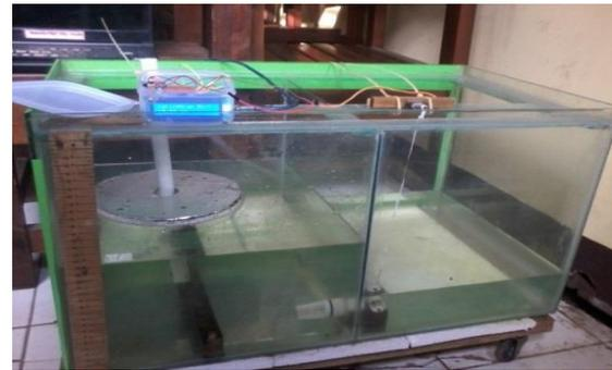
Gambar 4. Alat Ukur Tinggi Permukaan Air
